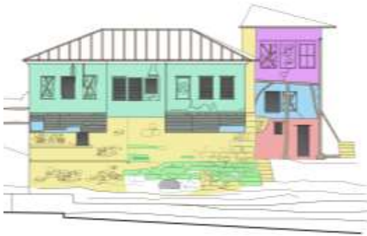
Σχ. 2 Νότια όψη. Υλικά κατασκευής
